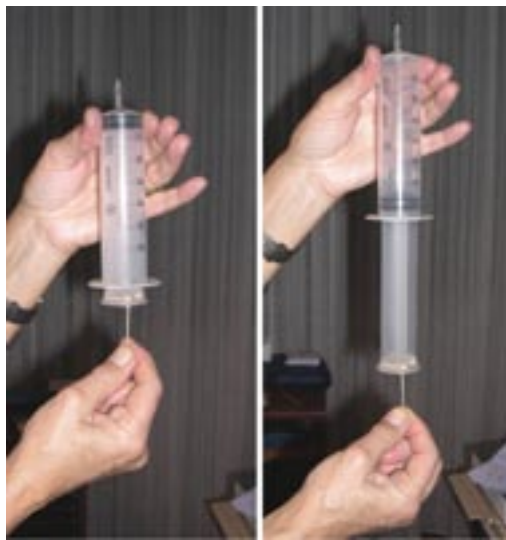
Figura 8 - Come misurare la pressione atmosferica dalla forza necessaria per estrarre lo stantuffo da una siringa chiusa alla sommità.
