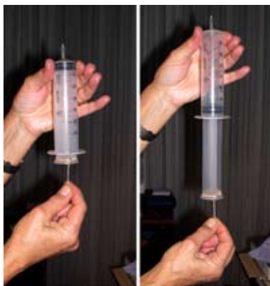
Figura 2 - Con una siringa tappata in alto si può determinare la pressione atmosferica dalla forza che occorre per estrarre lo stantuffo. Galileo credette di avere invece ottenuto una misura dell'inesistente "forza del vuoto" di aristotelica memoria.
